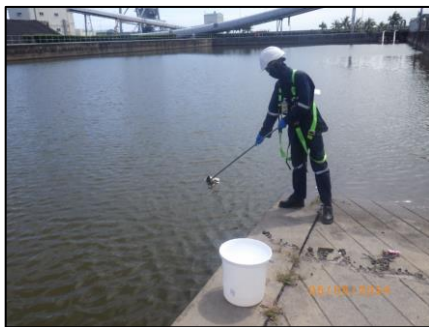
รูปที่ 3-6 การเก็บตัวอย่างน้ำเสียและน้ำที่ผ่านการบำบัดจากระบบบำบัดน้ำเสียจากกิจกรรมท่าเรือและลานกองเก็บถ่านหิน เมื่อวันที่ 5 มิถุนายน พ.ศ. 2567
